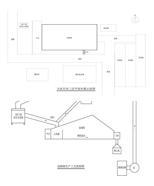
煤泥高频筛主要用于末精煤脱水。工艺流程图如下:
